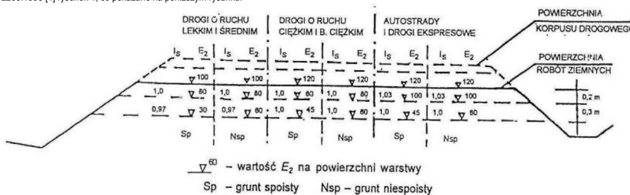
Rysunek 4 - Wartości wymagane w podłożu wykopów: wskaźnika zagęszczenia I_s i wtórnego modułu odkształcenia E_2 , megapaskali
